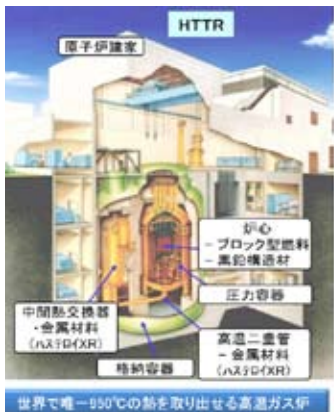
世界で唯一950℃の熱を取り出せる高温ガス炉
