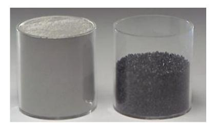
灰をガス化炉内で溶かして、ガラス 状のスラグとして排出するため容積 がほぼ半減
