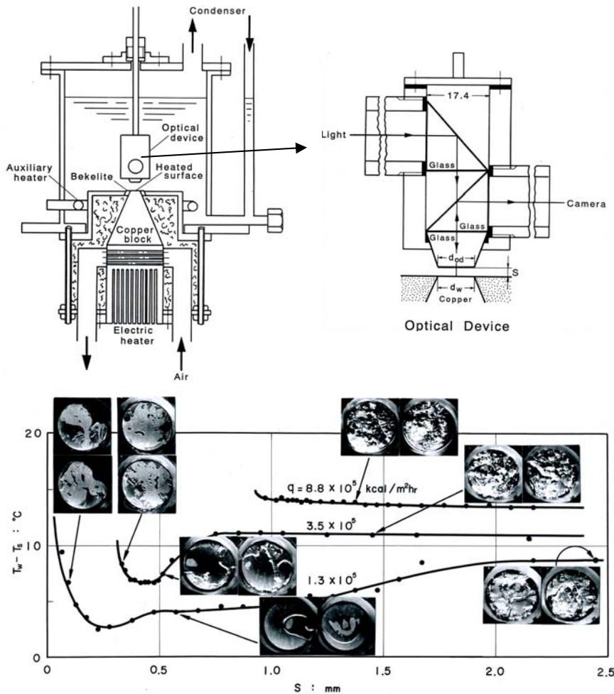
上図の実験装置で観察用の光学プリズム（干渉板）を加熱面に近づけていったときの伝熱特性への影響を調べたもの。高熱流束下ではプリズムが加熱面の近くに及ばない限り影響が現れておらず、沸騰伝熱が加熱面のごく近傍の現象に支配されていることがわかる。
