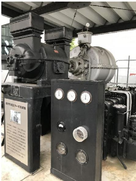
図1 現存する最古の高砂荏原式ターボ冷凍機
