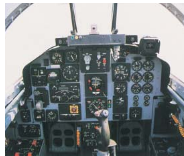
●コックピットに発煙油量計や低高度警報灯などを追加
