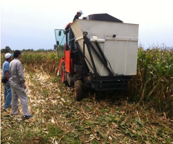
コンバインのトウモロコシ刈り取り試験@タイ (手前側)
