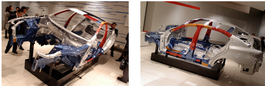
Infiniti Q50の車体。色は展示用に高張力鋼板の使用箇所を分かりやすくしたもの
