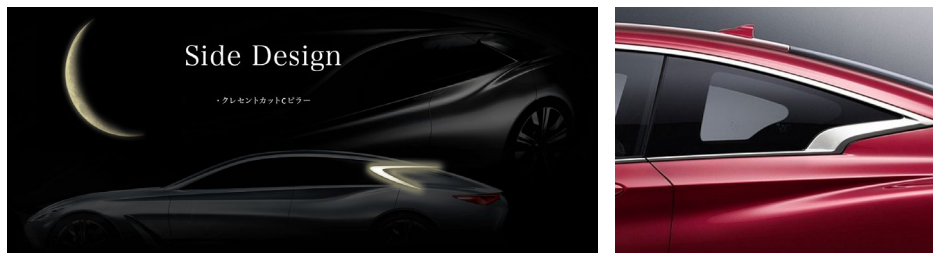
クレセントカットCピラーの概念(左)とInfiniti Q60の実際のサイドウィンドウ(右)
