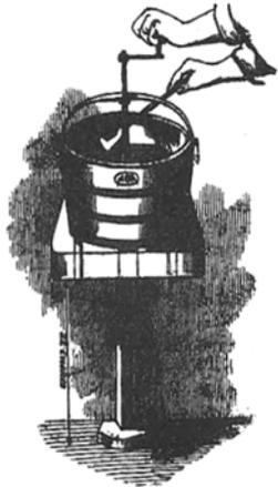
左手で寒剤を入れた容器中の凍結すべき液の入ったボウル型容器を回転させ、右手のヘラで掻き落とす
